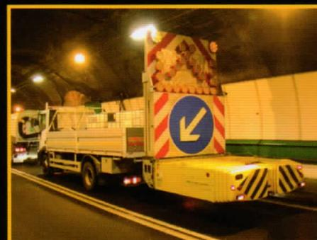
Autocarro omologato con assorbitore d'urti (TMA) e figura 401 Cds luminosa.
